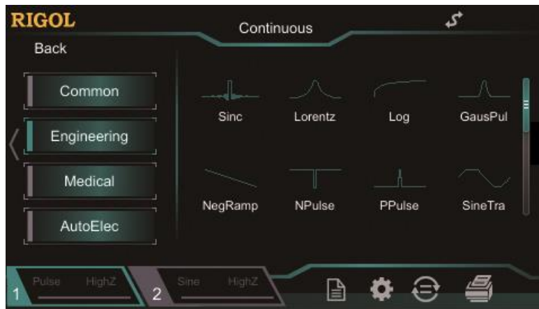
Figure 2-4 ビルトイン波形選択インタフェース
